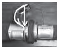
ツメ先端を押輪の後ろに滑り込ませる。
