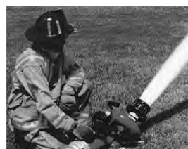
普段はタンク消防車の固定モニター（放水砲）として消防車デッキに搭載し、いざというときには、抜群の放水安定性を持つポータブルモニターに早代わりする全く新しい発想の放水砲です。しかも、放水の安全性に配慮した緊急遮断機構（安全弁）を組み込む等あらゆる放水条件を配慮したデザインです。消防車搭載のための必要機器は、システム標準仕様としてセットでお届けします。
