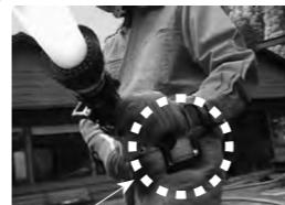
発売以来、ご好評いただいているe-管そう、e-ノズルアタッチメントに無反動アルファーの機能を持たせたハイブリッドモデルです。放水の安全作業、省力化に貢献いたします。放水の反動力は、腰骨の位置でシッカリと受け止めます。
