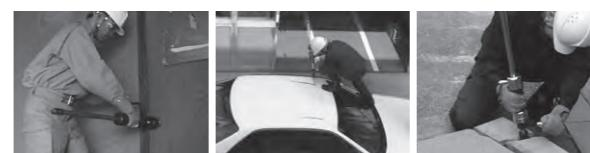
ドアノブ破壊・開錠機能 車両等の破壊救助機能 ブロック等・破壊救助機能
