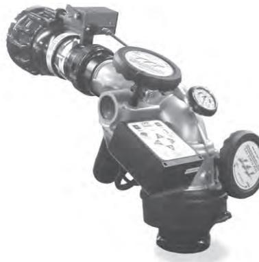
上下作動部は、独自な差動ギアーシステムにより駆動されます。これにより管内圧損は最小限に抑えられます。ギアー等は全てカバーで完全に保護されています。
